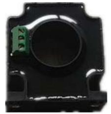
CTN300LTP 系列电流传感器应用霍尔效应，零磁通原理能在电隔离的条件下精确测量的直流、交流、脉冲以及各种不规则波形的电流。
